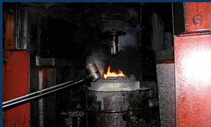
Das Schmieden ist ein sehr alter Arbeitsvorgang. Verschiedenartige Legierungen sind für diese Art von Verarbeitung geeignet. Die plastische Umformung, die durch diese Technik erzielt wird, ermöglicht die Herstellung von verschiedensten Teilen, die allesamt sehr hohen Belastungen standhalten, sehr kompakt sind und optimal weiterverarbeitet werden können.
